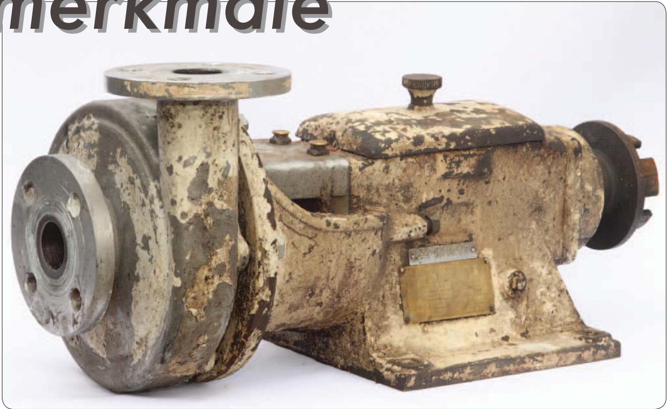
Diese Bungartz Pumpe ist Baujahr 1949 – sie kam 2012 nach 63 Jahren Standzeit im Betrieb zum Service.
